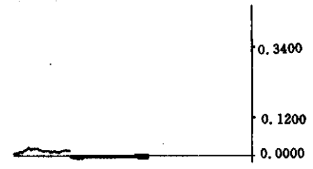
图 1 不加 \text{Ba}(\text{OH})_2 时 30\mu\text{L} 0.50\mu\text{g/mL} 硼标样的积分曲线
